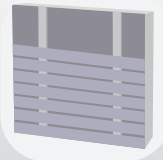
Pose horizontale simple lambourrage
